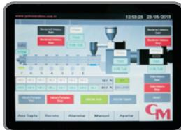
Kolay bir kullanım için tasarlanmıştır. Standart 10 " Dokunmatik ekran kontrolü sayesinde vida ve beslemelerin devirlerini ayarlayabilir, kafada oluşan basıncı ve diğer parametreleri görebilirsiniz. Bununla birlikte formüllerde kullandığınız değerleri cihazın hafızasına kaydedebilirsiniz. Böylelikle hafızada kayıtlı formüllerinizi numarasını ya da ismini yazarak çağırabilir ve cihazı kullanma hazır konuma getirebilirsiniz.
